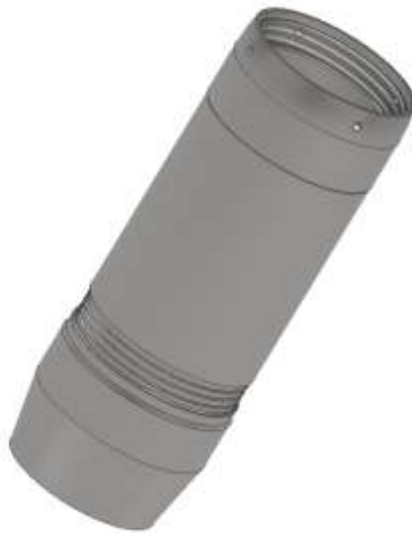
Рис. 1. ЗД модель корпусу для кумулятивного снаряда
