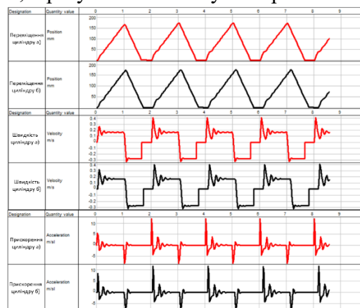
Рис. 1. Отримані залежності позицій, швидкостей та прискорень гідроциліндрів: а) — в системі з пропорційним розподільником; б) — з дискретним
