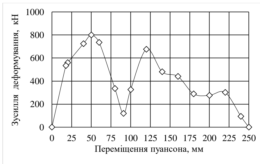
Рис. 3. Графік залежності зусилля витягування з потоншенням від переміщення пуансона
