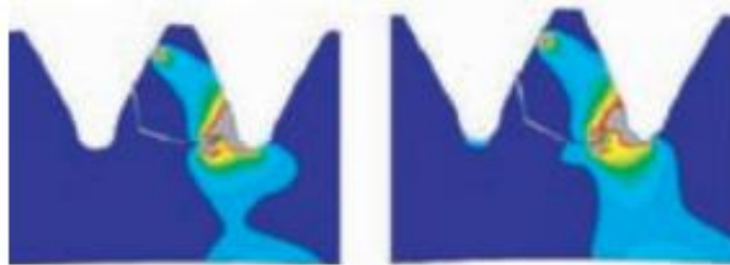
Рис. 1 Пошкодження зубчастого колеса в результаті утворення припалів
