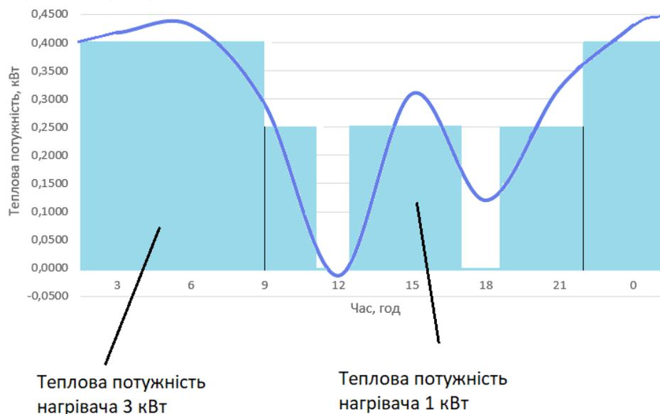
**Рис. 2. Прогнозована зміна втрати теплової потужності з циклограмою включення та вимкнення компенсуючих нагрівачів**
